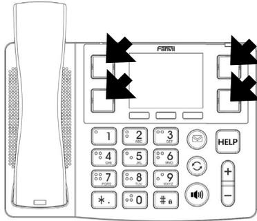
Das Fanvil X305 verfügt über 4 frei programmierbare Tasten neben beiden Seiten des Displays.
